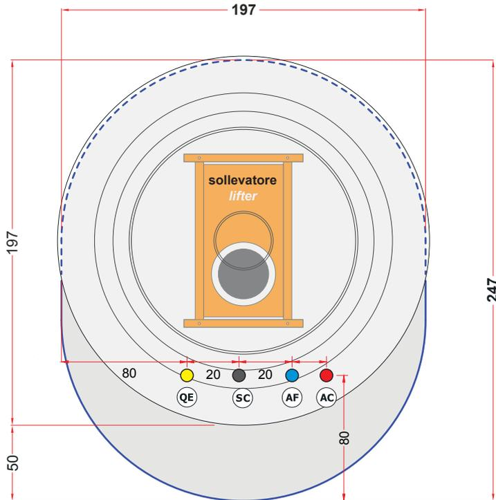
PROVVEDERE AL FISSAGGIO A TERRA DEL SOLLEVATORE SOLO DOPO AVER VERIFICATO LA CORRETTA ESCURSIONE DELLA VASCA.
