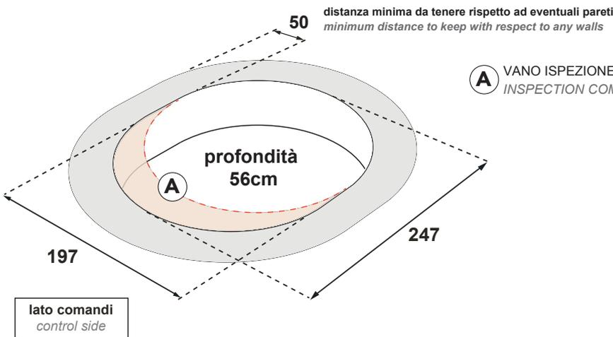
**A** VANO ISPEZIONE con pavimento removibile (solo sul lato impianti)
